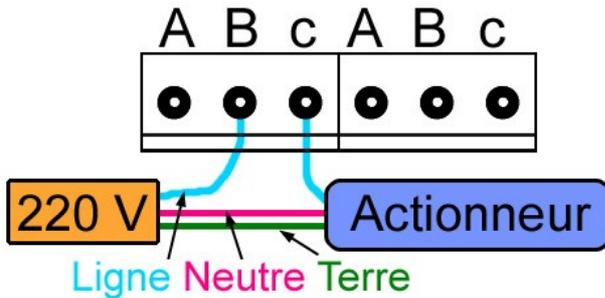
Ce montage permet de piloter un actionneur en On/Off. Attention, le 220V peut rester présent sur l'une des deux bornes de l'actionneur.
