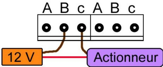
L'actionneur peut être une lampe de n'importe quel type, un moteur ou tout système électrique que l'on veut piloter directement en On/Off.
