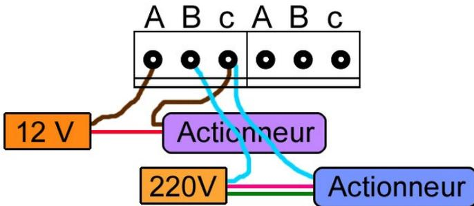
Les deux côtés d'un relai, A et B, étant électriquement indépendants, on peut piloter simultanément deux objets indépendants.
