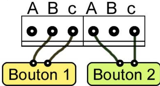
Si le bouton à remplacer établit un contact lorsque l'on appuie dessus, on utilise le montage de gauche : on connecte les fils du bouton sur les plots B et c de la sortie. L'activation du relai mime l'appui sur le bouton.
