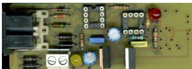
Prise Midi, à l'extrémité de la carte du côté des diodes. Il peut s'avérer nécessaire de couper les socles en plastique derrière la prise s'ils gênent d'autres composants.
