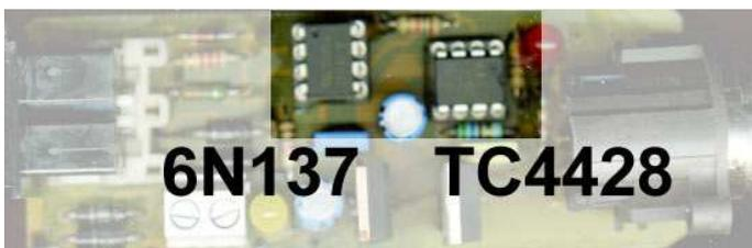
Enficher le 6N137 et le TC4428 dans le bon sens sur les supports DIL8 en respectant l'alignement de l'encoche. L'encoche sur les composants est parfois remplacée par un point.
