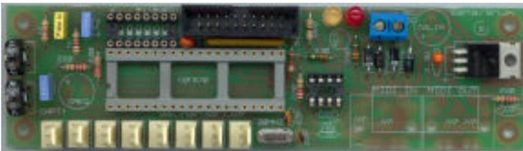
*8 Connecteurs 3 points* pour capteurs analogiques.
