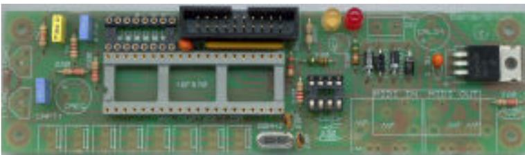
*Connecteur 20 points* pour fil en nappe, pour les entrées numériques. Ce connecteur est **orienté**, le détrompeur tourné vers le bord de la carte.
