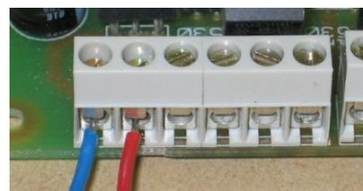
Il est possible de brancher au maximum **deux LED** en série par sortie. Les résistances présentes sur la carte servent à réguler le courant dans les LED. Si l'on branche plus de deux LEDs par sortie, elles éclairent nettement moins fort. Si vous désirez piloter plus de LED individuellement, vous pouvez utiliser une carte 64 Led, si vous désirez piloter plus de groupes de Led qui évoluent de la même façon, vous pouvez utiliser une carte 8 Transistors de puissance.
