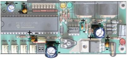
2 Condensateurs électrochimiques 220  $\mu$ F. Ils sont situés près des diodes et du potentiomètre. Ces condensateurs sont orientés. **Leur mise à l'envers provoque leur destruction**. La patte la plus longue est la patte +. L'autre patte à la barre verticale d'une autre couleur, avec des flèches < <).
