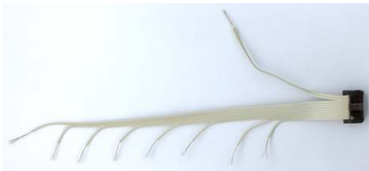
Fils dénudés à l'extrémité
